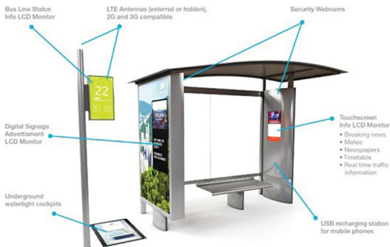
شکل ۳: چشم انداز اریکسون از نحوه اتصال ایستگاه‌های اتوبوس به یکدیگر.
