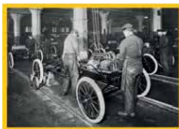
کارگران در خط تولید دگرگون‌کننده هنری فورد در حال ساخت خودروی مدل T هستند. فورد با دوراندیشی تشخیص داد کارگانش باید بهترین مشتریانش نیز باشند.
